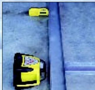
RUGBY 200 mit Rod-Eye Pro im Vertikalbetrieb
